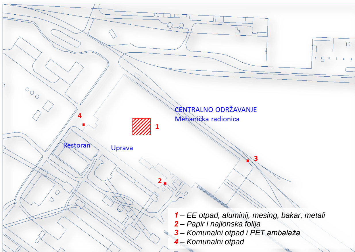
Slika 1.16. Šematski prikaz lokacija za privremeno skladištenje otpada u departmentu Centralno održavanje (zajednička grupa i dijagnostika)
