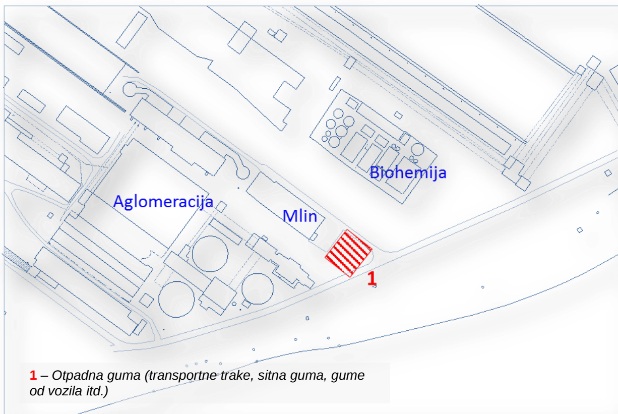
Slika 1.20. Šematski prikaz centralnog skladišta za otpad od gume
