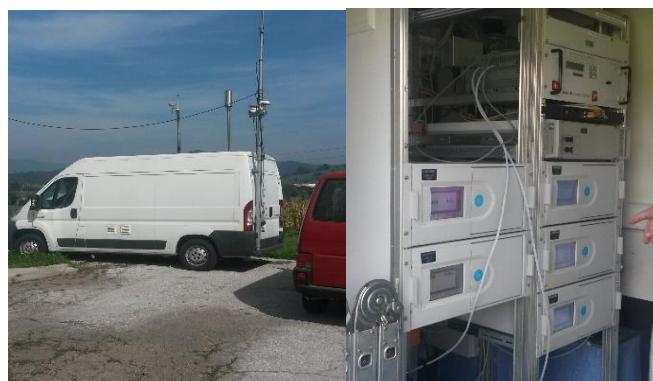
Slika 14. Mobilna automatska stanica za monitoring kvaliteta zraka
